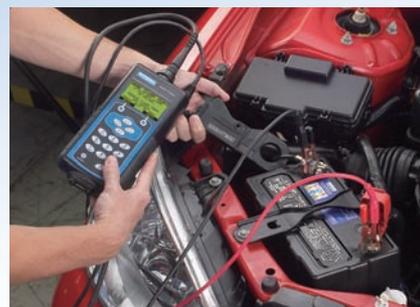
L'utilisation de la pince ampérométrique en option permet d'atteindre un niveau élevé de diagnostics, au delà de la simple détection d'une chute de tension du démarreur. Les diagnostics du démarreur EXP dévaluent le débit en ampères, les chutes de tension, le temps de démarrage et la résistance du circuit du démarreur pour des résultats plus précis.
