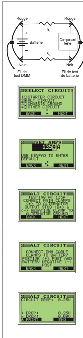
Procédure de test du circuit de l'alternateur
